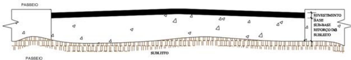
O problema geral do dimensionamento consiste em considerar um ponto P qualquer do sistema, no sub-leito ou no pavimento e determinar, para este ponto, quando o sistema é solicitado por uma carga de roda  $Q$ , o estado de tensão, a deformação e se vai ou não, haver ruptura.
