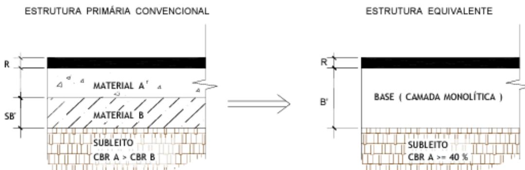
Em função dos parâmetros obtidos anteriormente obtém-se as espessuras totais necessárias à proteção do sub-leito, sub-base e base.
